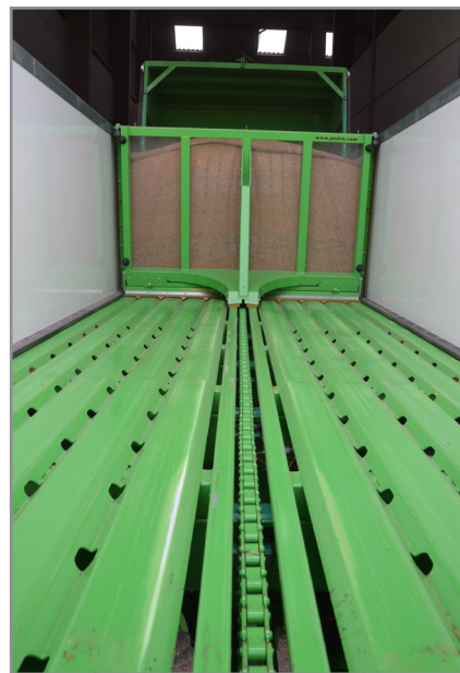
DRAKKAR CATENA®: durante la descarga, la cadena de asistencia duplica la fuerza de transporte de la carga sobre la cual la pared de plexiglás ofrece una visibilidad total.
